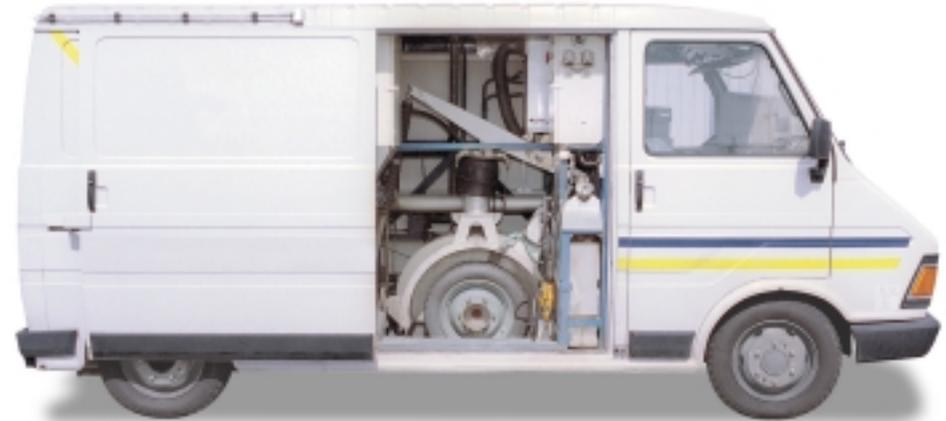
Roue de mesure instrumentée
