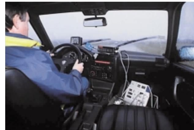
Essayeur au volant d'un véhicule instrumenté lors d'un test d'adhérence transversale.
