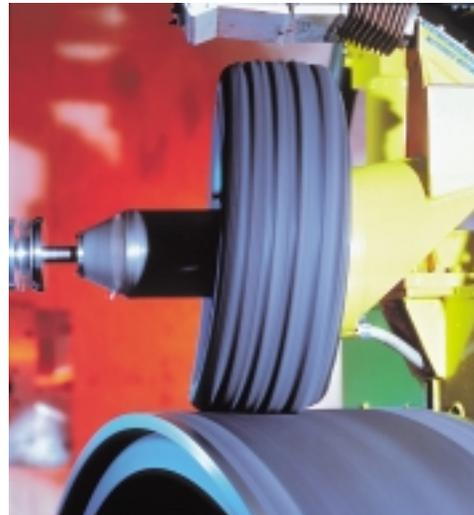
Rouleuse en fonctionnement. Ici, le pneu roule à l'extérieur du "volant".
