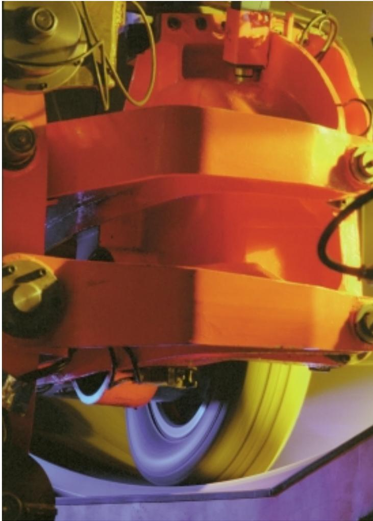
Rouleuse en fonctionnement. Ici, le pneu roule à l'intérieur du "volant".
