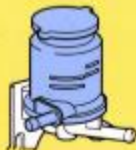
Réservoir de secours
