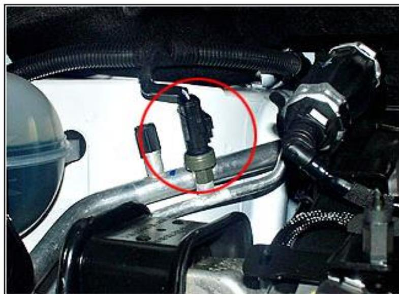
Monté sur le circuit de réfrigération, en amont de l'évaporateur, il mesure la pression du fluide frigorigène.
