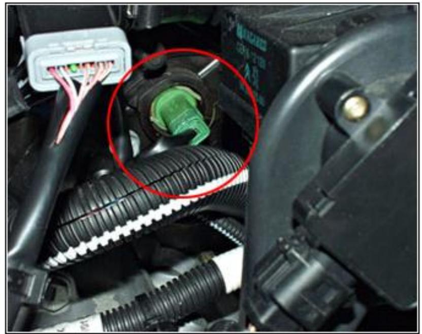
Implanté sur le boîtier de sortie d'eau, il informe le calculateur de contrôle moteur de la température du liquide de refroidissement moteur.
