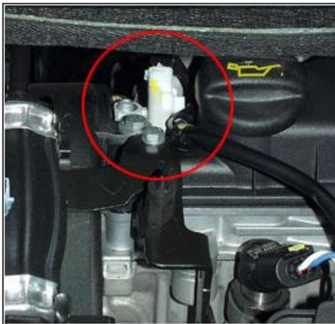
Ce capteur permet d'identifier le cylindre en phase compression afin de pouvoir caler l'injection de carburant dans l'ordre d'allumage 1-3-4-2.
