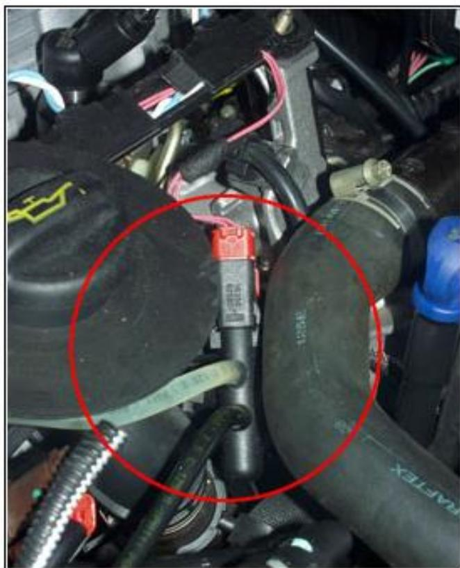
Situé sur le circuit de retour carburant, il informe le calculateur de contrôle moteur de la température du gazole.
