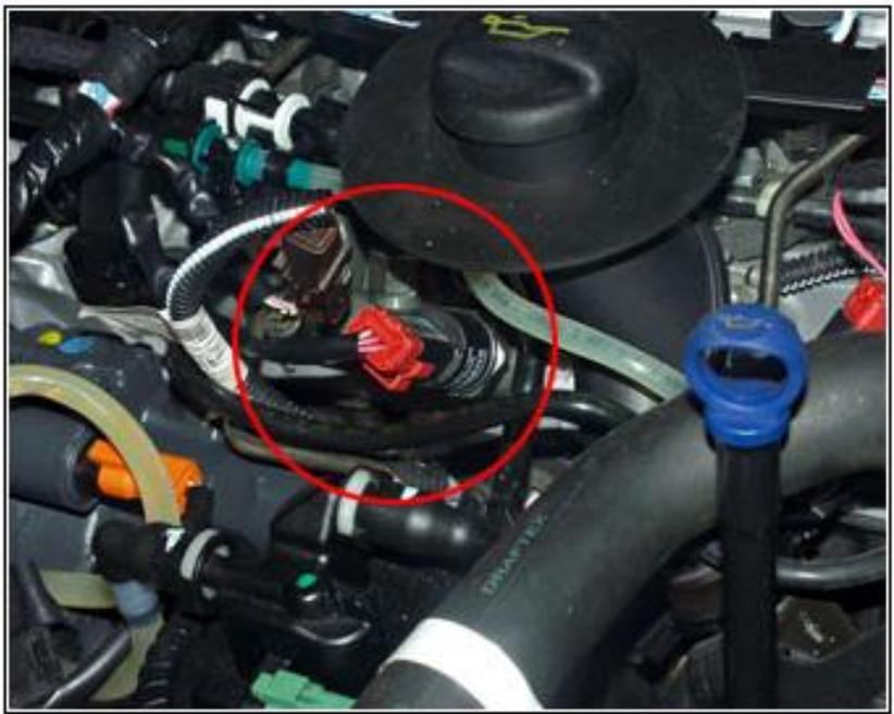
Il permet de déterminer la pression de carburant qui règne dans la rampe d'injection.
