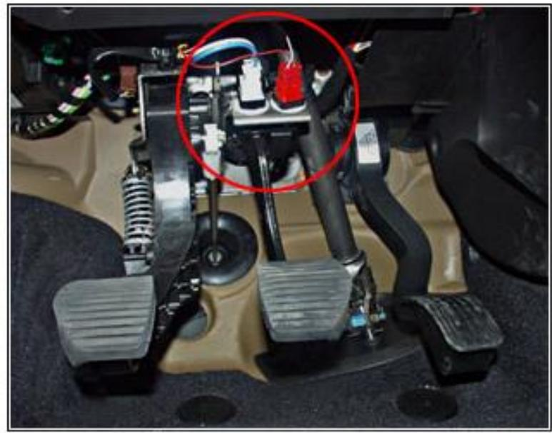
Appelé aussi "contacteur de sécurité du régulateur de vitesse (freins)" fixé sur la pédale de freins, il détecte une action du conducteur sur la pédale de freins.
