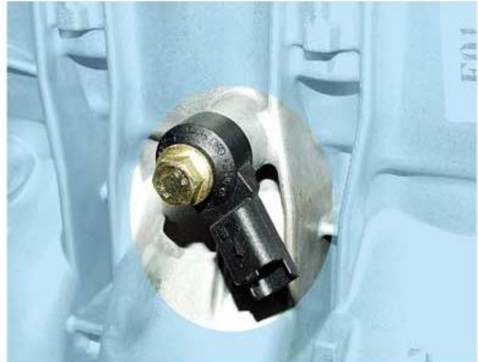
**Il est impératif de respecter le couple de serrage de ce capteur, afin de ne pas créer une précontrainte néfaste au bon fonctionnement.**
