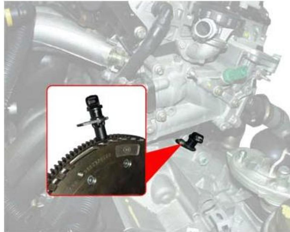
Ce capteur est placé en regard d'une cible, entraînée par l'arbre à cames.
