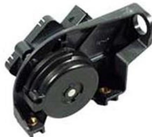
**Maintenance : elle consiste à réaliser un apprentissage du capteur pédale accélérateur à l'aide de l'outil de maintenance électronique.**
