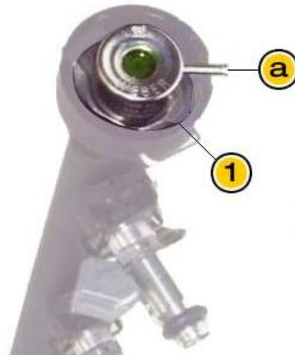
La régulation de la pression d'injection est assurée par le régulateur.
