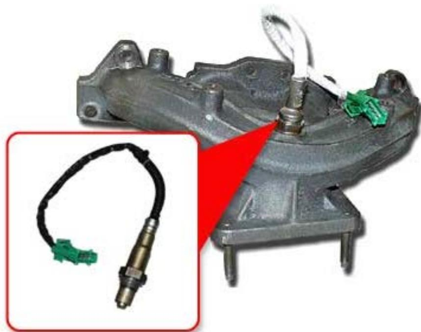
Exemple de sonde à oxygène implanté sur le collecteur.
