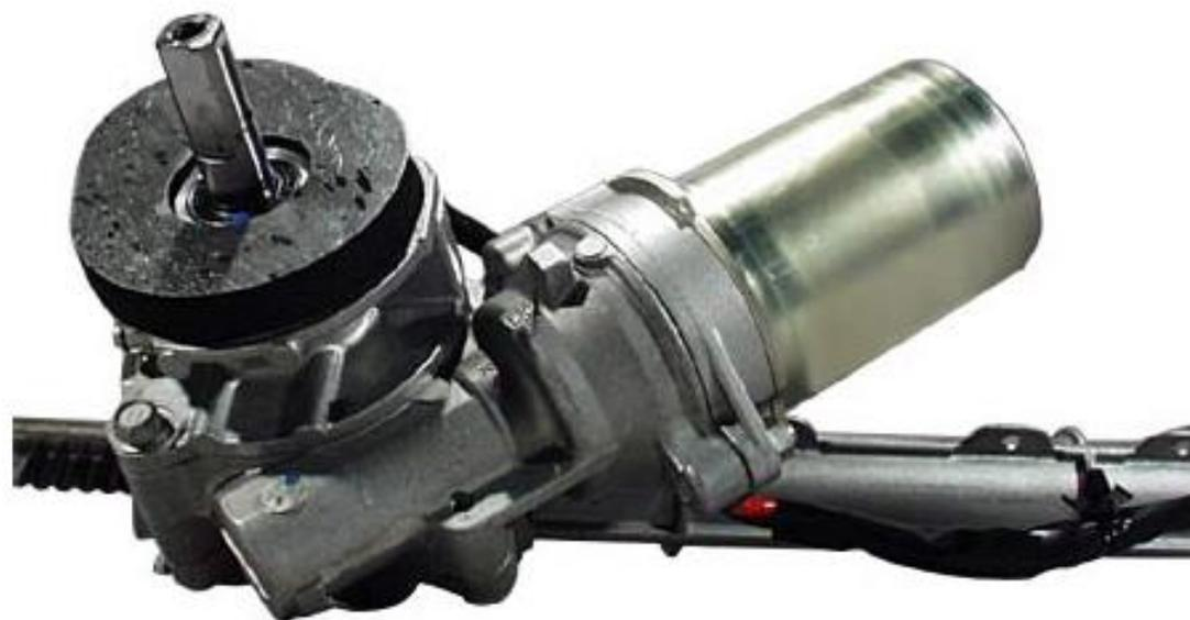
Le boîtier de direction intègre un capteur de température.
