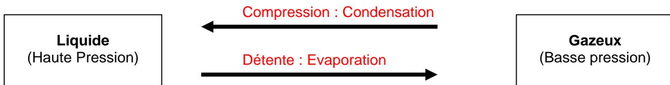
Lorsqu'un corps passe de l'état liquide à l'état gazeux, il s'évapore et absorbe de la chaleur du milieu extérieur. A l'inverse lorsqu'un corps passe de l'état gazeux à l'état liquide, il se condense et cède de la chaleur au milieu extérieur.
