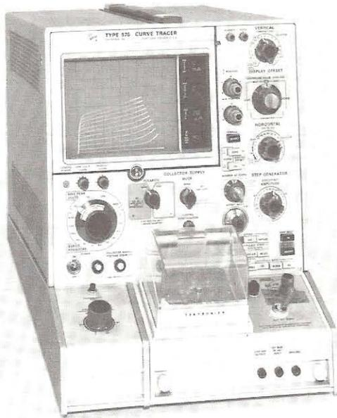
Fig. 65 Enregistreur de caractéristiques "Tektronix".
