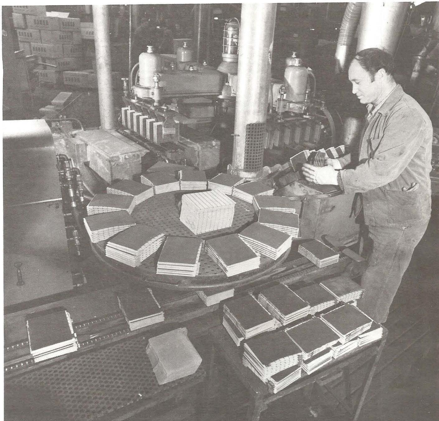
Fig. 4 Fabrication de faisceaux de plaques constitués de plaques positives, plaques négatives et séparateurs.
