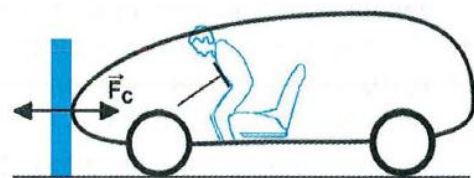
Figure 3.21 • Effet mécanique en cas de véhicule indéformable.
