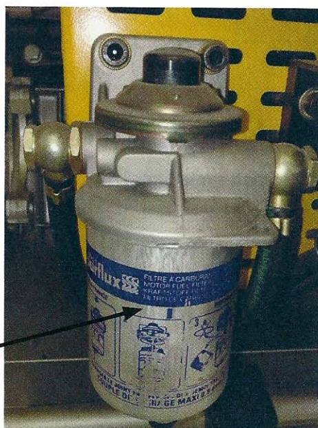
Montage des raccords par vis et joints en cuivre
