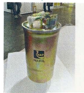
Cartouche filtrante avec joints, clips et raccords rapides
